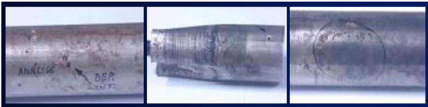
Normalmente ocorrem ataques ácidos localizados sob depósitos, resultando em cavidades com superfícies internas lisas e brilhantes, após a remoção dos produtos de corrosão.
