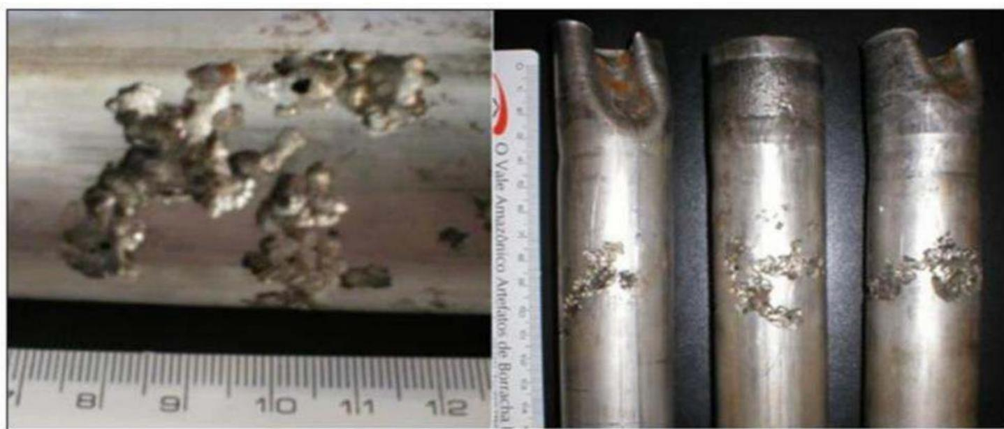
*Aquecedor de usina de açúcar construído em aço inox AISI 304 que sofreu um processo corrosivo por microorganismo.*
