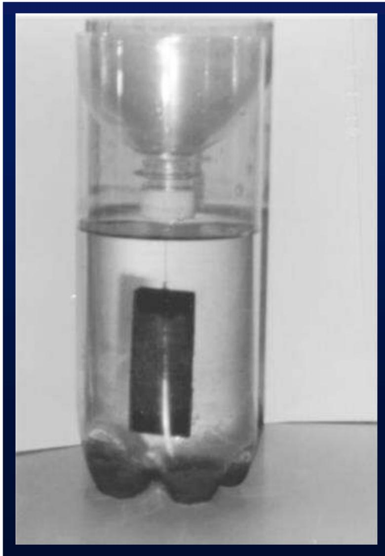
**Material Metálico:** Chapa plana de aço Carbono 1020, recozido, acabamento laminado a frio, suspensa por fio de nylon.
