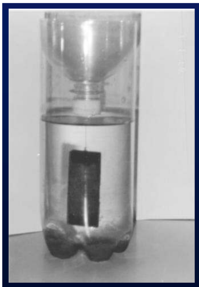
Ensaio simples de Corrosão Generalizada
