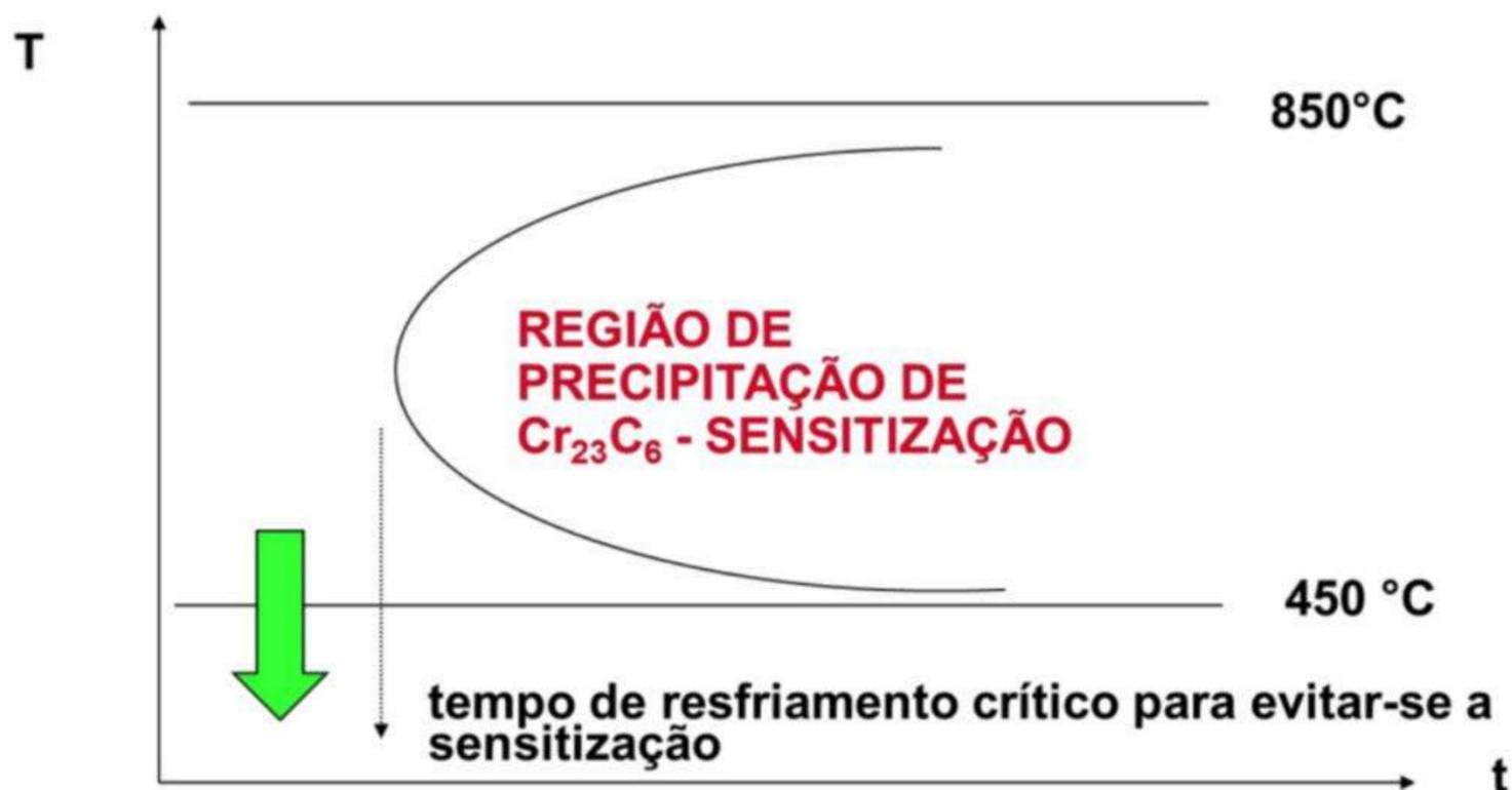
Cada aço, com o seu teor de Carbono real, apresenta uma curva em formato de "C", no interior do qual acontece a zona de precipitação, para uma dada temperatura T e um tempo de permanência t.
