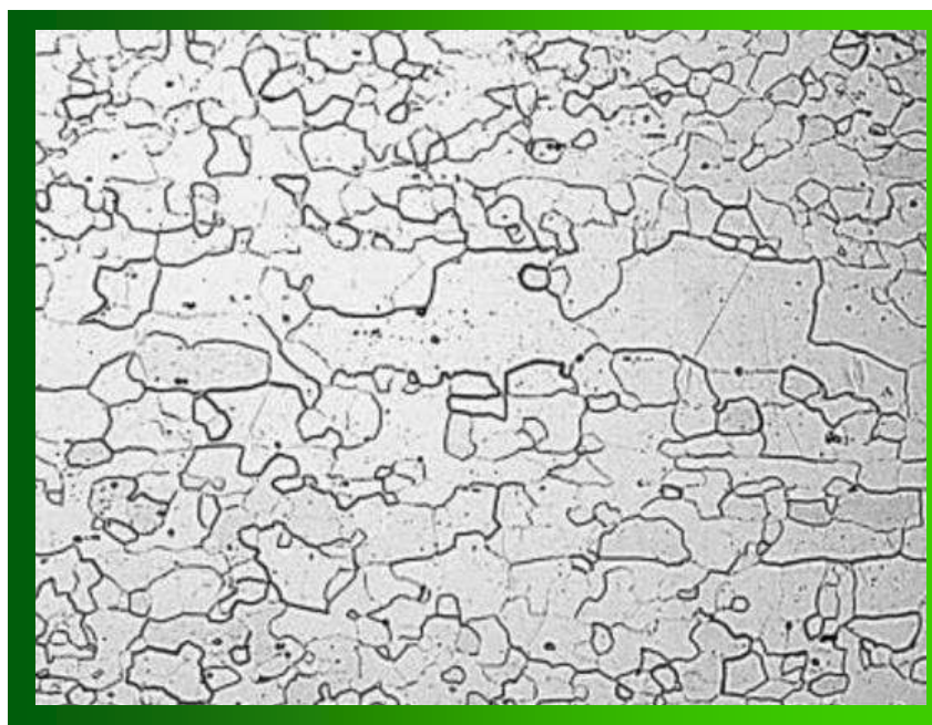
Fig. 2: Microestrutura de um aço AISI 430
