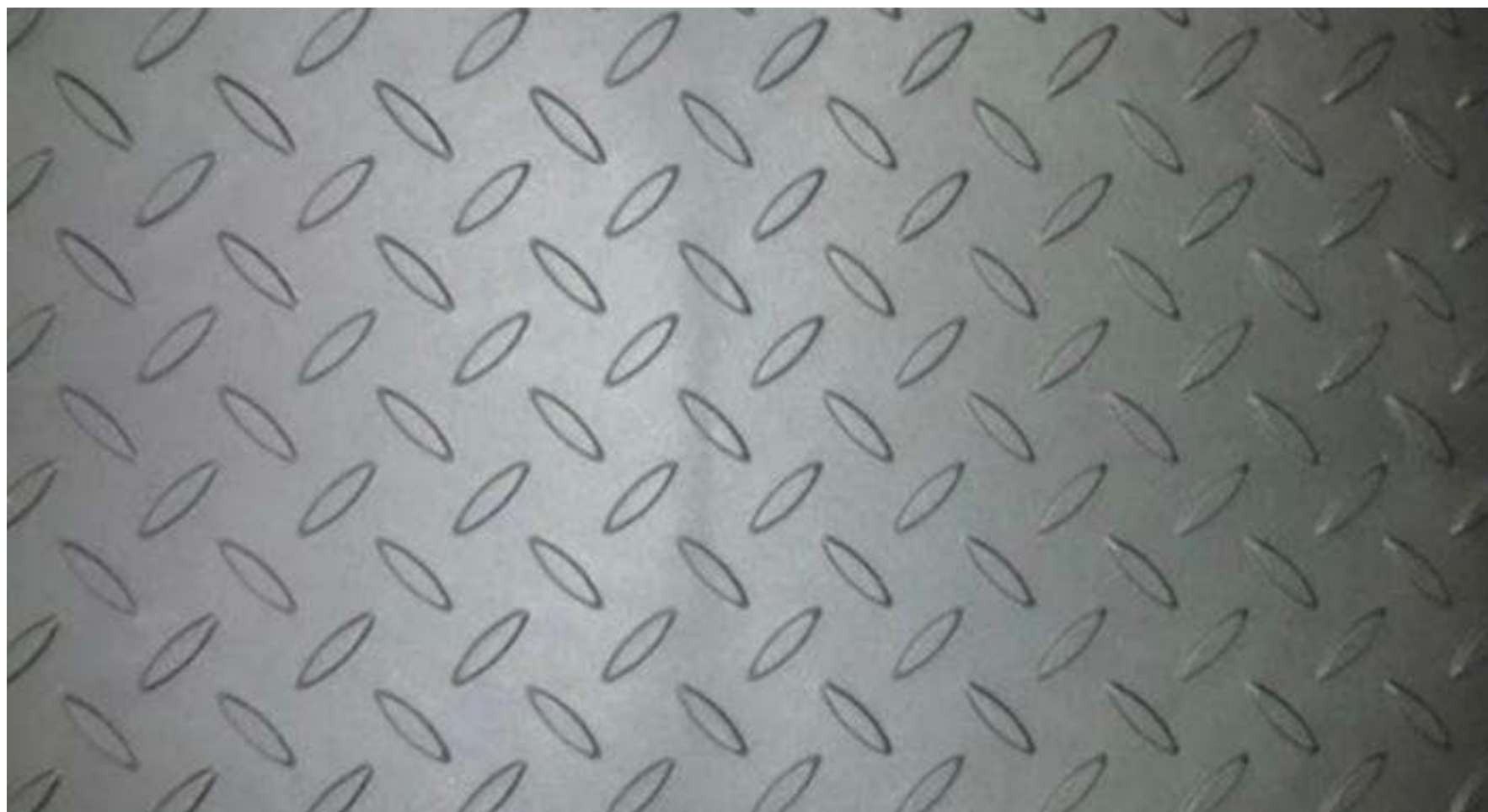
Figura 5: acabamento típico de uma chapa para piso
