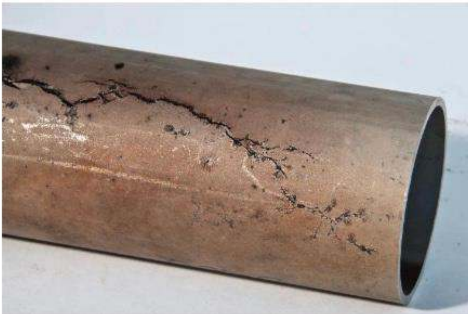
Figura 7. Corrosão sob tensão
