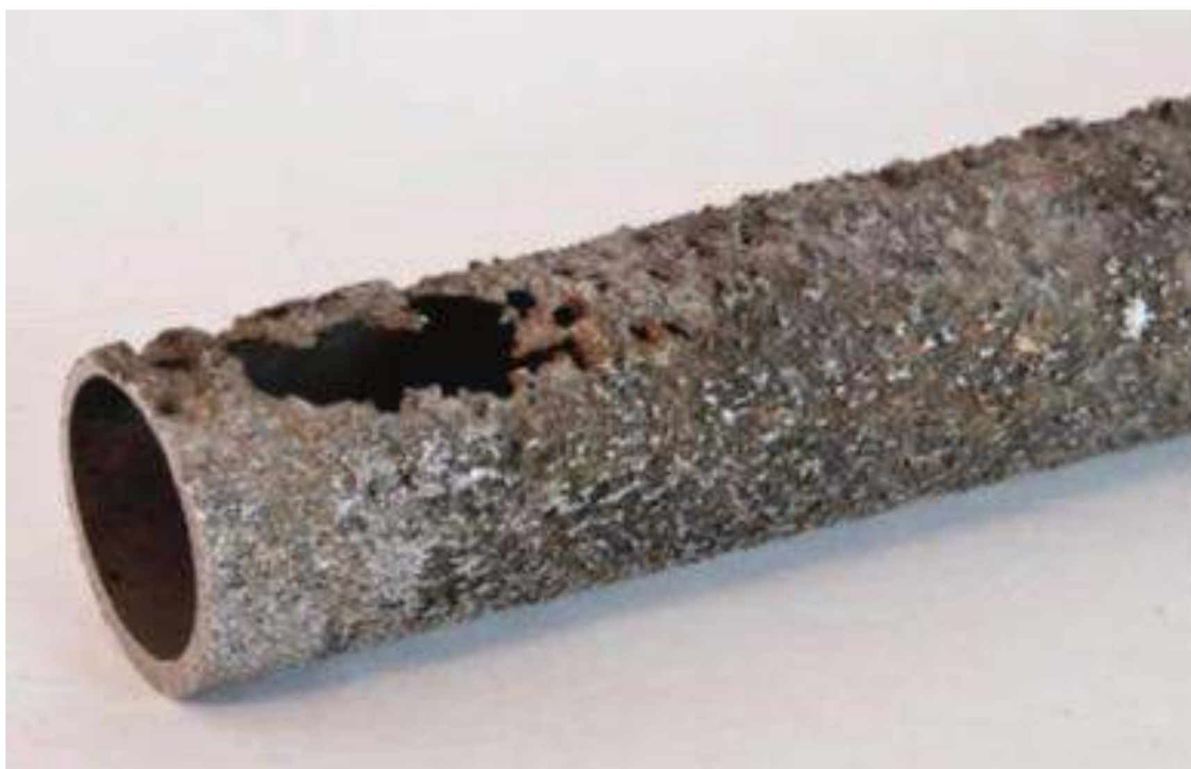
Figura 1. Corrosão generalizada em um tubo de vapor em aço inox exposto ao ácido sulfúrico
